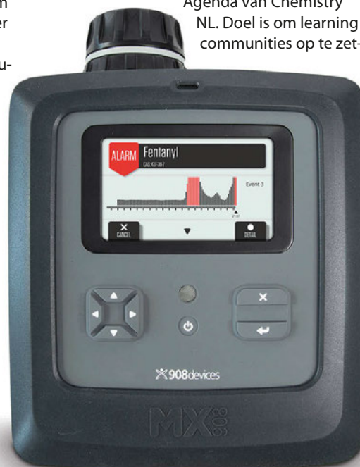
MX908 is een multi-missie handheld massaspectrometer om onder andere chemische stoffen te detecteren (foto: 908 Devices)
