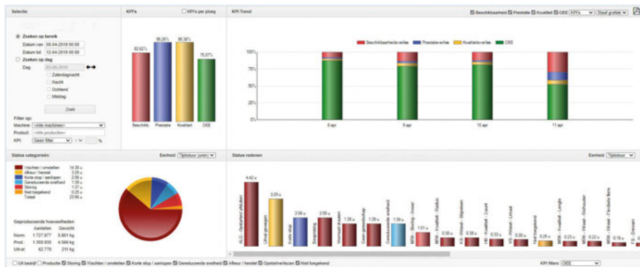
Weergave van de activiteiten van een van de productielijnen met een gedetailleerd overzicht van stops, storingen, wachten/omstellen, afkeur, etc.
